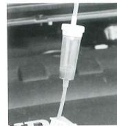
注入は点滴に似た装置を用いる。オイルのレベルゲージからゆっくりと時間をかけて入れるのがポイントだ。施工の仕方で効果も半減してしまうので注意が必要だ
